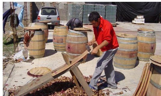
Abhobeln von Fassdauben bei der Barrique-Renovierung in Chile
