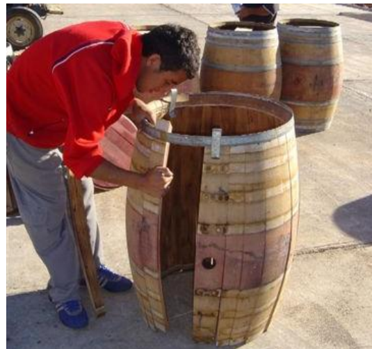
Zusammensetzen der nummerierten und abgehobelten Fassdauben
