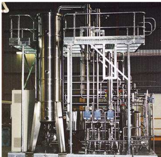
Eine typische Spinning Cone Column-Anlage von Alfalavel
